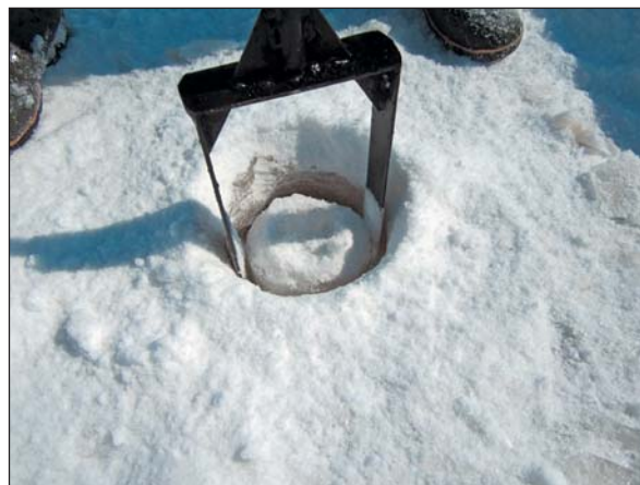
Кольцевой бур. Позволяет получить керн льда любой толщины.
